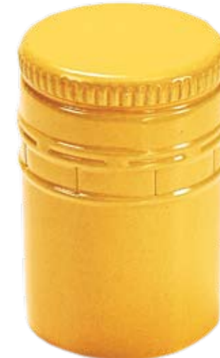
(5) Drehverschluss mittellang, Aluminium mit zinnbeschichteter Kunststoffdichtung pos.: dicht, geruchsneutral, zum Wiederverschließen, hörbarer Knack-Effekt, seit 30 Jahren erprobt neg.: nur für relativ kurze Lagerzeit geeignet, Recycling aufwendig Kosten 10–20 Cent *
