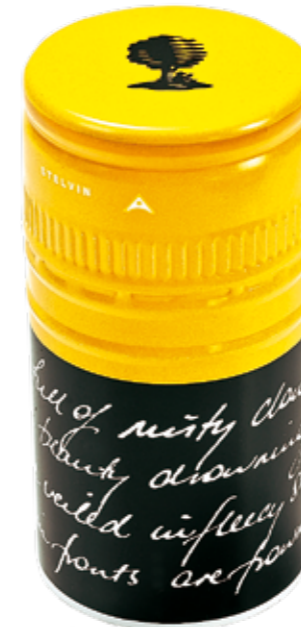
(4) Drehverschluss lang, Aluminium mit zinnbeschichteter Kunststoffdichtung pos.: dicht, geruchsneutral, hörbarer Knack-Effekt, zum Wiederverschließen, seit 30 Jahren erprobt neg.: nur für relativ kurze Lagerzeit geeignet, Recycling aufwendig Kosten 10–20 Cent*
