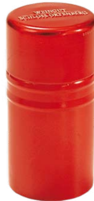
(3) Drehverschluss lang, mit unsichtbarem Innengewinde, Aluminium mit zinnbeschichteter Kunststoffdichtung pos.: dicht, geruchsneutral, hörbarer Knack-Effekt, zum Wiederverschließen neg.: keine Langzeiterkenntnisse, Recycling aufwendig Kosten 15–30 Cent*
