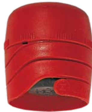
(1) Kunststoffverschluss mit polymerummantelter Aluminiumdichtung, unsichtbares Innengewinde pos.: relativ dicht, geruchsneutral, zum Wiederverschließen, Siegelband neg.: laut Hersteller nur für Lagerdauer von maximal fünf Jahren geeignet Kosten ca. 14 Cent*
