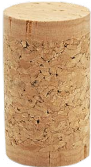
(8) Technischer Kork bzw. Agglomeratkork aus Korkgranulat und Leim pos.: Granulat und Klebstoff durch „Twin-Top“-Korkscheibe vom Wein getrennt, in der Flasche Optik wie Naturkork neg.: Presskork ohne trennende Korkscheibe mit bekannten Nachteilen (Klebstoff) Kosten 12–17 Cent *
